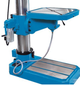
Výšku vrtacího stolu lze motoricky přestavovat
