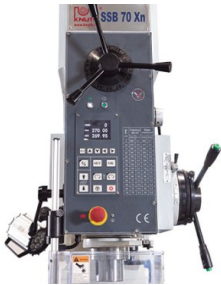
La velocidad del husillo, el tope de profundidad y la posición del eje hueco se muestran en la pantalla
