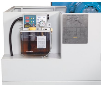
Un sistema automático de lubricación central abastece continuamente todos los puntos de lubricación y simplifica el mantenimiento. El lubricante se almacena en un depósito central y se distribuye a través de conductos a todos los puntos de lubricación. El lubricante se dosifica mediante control electrónico
