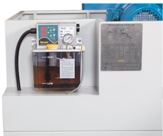
Un sistem de lubrifiere centrală alimentează, automat și continuu, toate punctele de lubrifiere ale unei mașini, cu lubrifianțul necesar. Un rezervor central stochează lubrifianțul, care este distribuit către punctele individuale de lubrifiere, prin intermediul unui sistem de conducte. Dozarea este controlată în mod electronic
