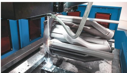
Bei der additiven Fertigung entstehen komplexe Bauteile auf einer Metallplatte, die anschließend vom Bauteil getrennt werden muss (Neospark 500 B Continental Engineering Services)
