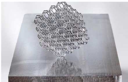
Структуры, сформированные послойно, разрезаются опорной пластинкой
