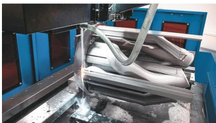
В процессе аддитивного производства сложные компоненты создаются на металлической пластине, которая затем отделяется (NeoSpark 500 B Continental Engineering Services)
