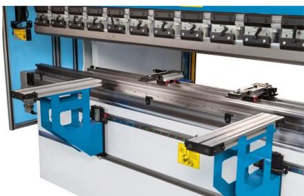
*Надежные передние опорные кронштейны можно быстро установить на нужную высоту с помощью стопорного механизма*
