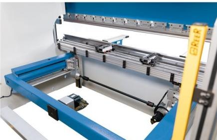
Option: Hinteranschlag mit gesteuerter R-Achse
