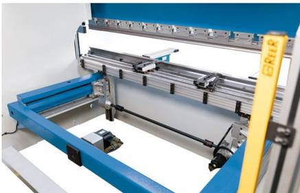
Option: Hinteranschlag mit gesteuerter R-Achse
