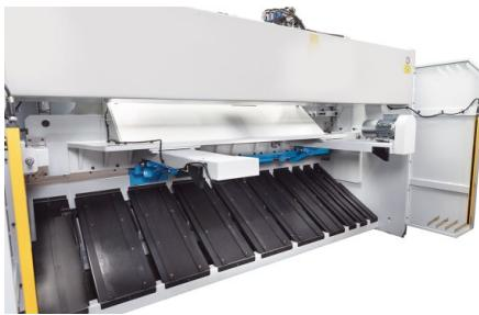
*Устройство для крепления стального листа с опциональным пневматическим управлением позволяет точно позиционировать у заднего упора даже тонкие листовые заготовки*
