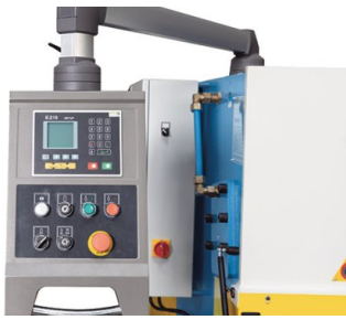
Sterowanie NC do szybkiego pozycjonowania ogranicznika tylnego
