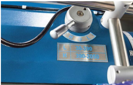
Accionamiento giratorio potente con caja de cambios auxiliar (Servomill® UWF 12)
