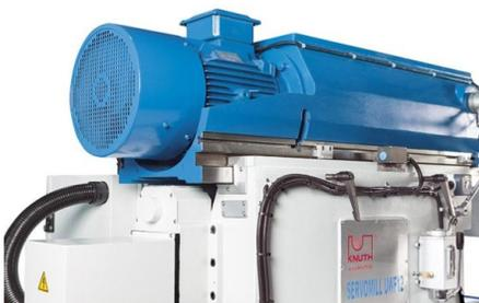
Potente motore per l'azionamento del mandrino con trasmissione con rinvio (Servomill® UWF 12)
