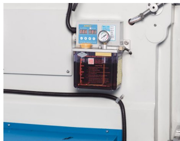
Automatyczne centralne smarowanie obniża koszty konserwacji
