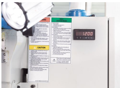
Plaja largă de turație poate fi reglată fără trepte
