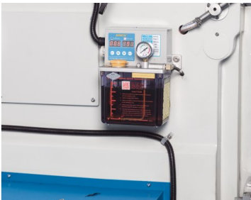
Система автоматической централизованной смазки сокращает потребность в техническом обслуживании
