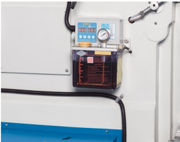
La lubricación central automática reduce el mantenimiento
