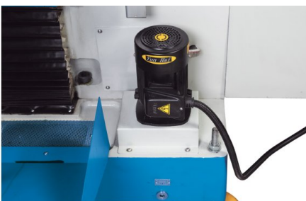
Integrovaný chladicí systém optimalizuje proces obrábění, zvyšuje životnost nástrojů a zlepšuje kvalitu povrchu obrobků
