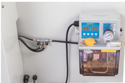
Průběžné a přesné mazání minimalizuje tření a opotřebení pohyblivých částí a prodlužuje životnost stroje
