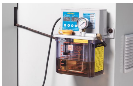
Непрерывная точная смазка сводит к минимуму трение и износ движущихся частей и увеличивает срок службы станка
