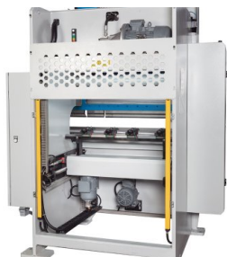
Ampio sbalzo e tavola ristretta per garantire molto spazio libero per piegature complesse
