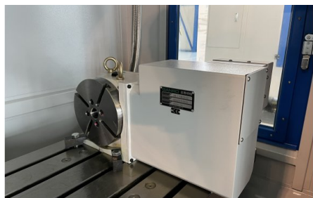
Podzielnica typu DR-170 ze stołem do mocowania 210 mm
