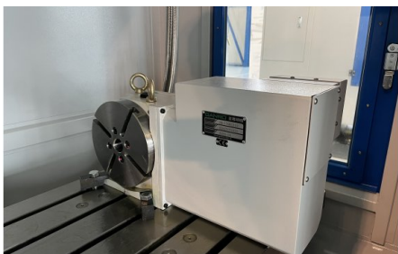
Diviseur type DR-170 avec table de serrage 210 mm
