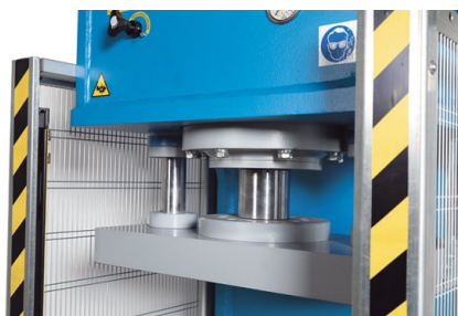
L'area di lavoro è protetta da una barriera ottica
