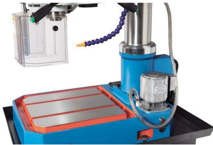
*Насос охлаждающей жидкости встроен в основание*
