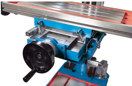
*Устойчивый крестовой стол обеспечивает точное позиционирование при выполнении отверстий в ряд или по схеме*
