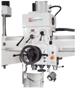
*Die Drehzahl ist in 2 Bereichen stufenlos regelbar und auf einen Display ablesbar*
