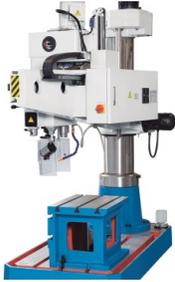
*Le fourreau dispose d'un système d'équilibrage du poids et se déplace facilement*
