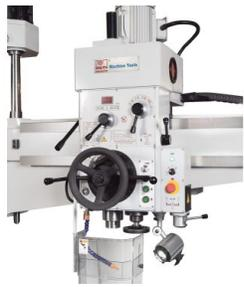
*Число оборотов плавно регулируется двухступенчатым редуктором и отображается на дисплее*
