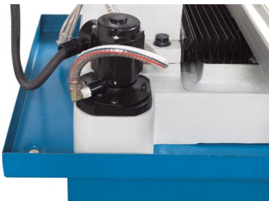
Sistema de refrigeración integrado
