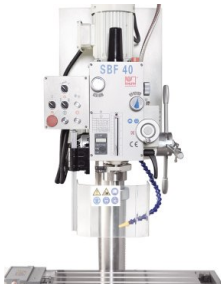
Pannello di controllo disposto in maniera chiara ed indicatore digitale di profondità
