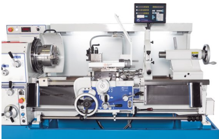
Nastavitelné dorazové vačky automaticky vypínají posuv
