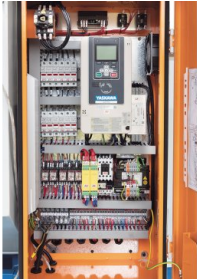
Плавная регулировка числа оборотов с помощью инвертора Yaskawa
