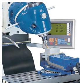
Фрезерная головка может поворачиваться в 2 плоскостях
