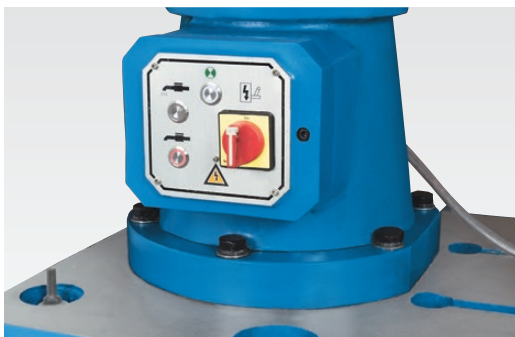
Stabiler Säulenfuß mit zentralem Hauptschalter
