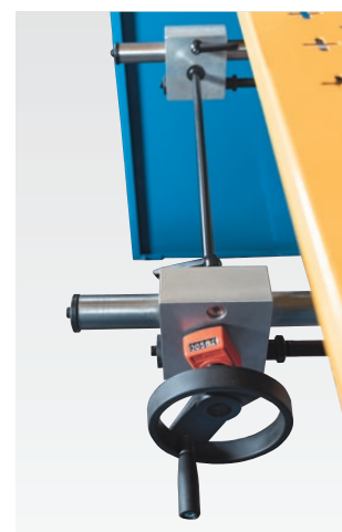
Manueller Hinteranschlag mit mechanisch-digitaler Positionsanzeige
