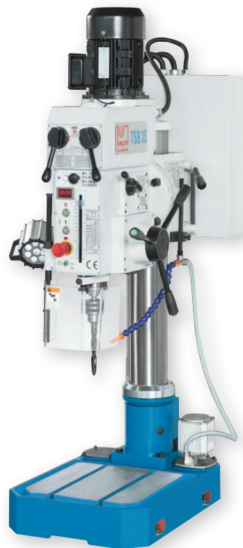
Abb. TSB 35 mit digitaler Drehzahlanzeige
