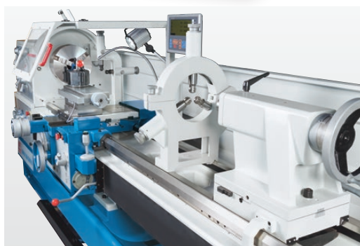
Lünetten zur präzisen Bebearbeitung langer Werkstücke
