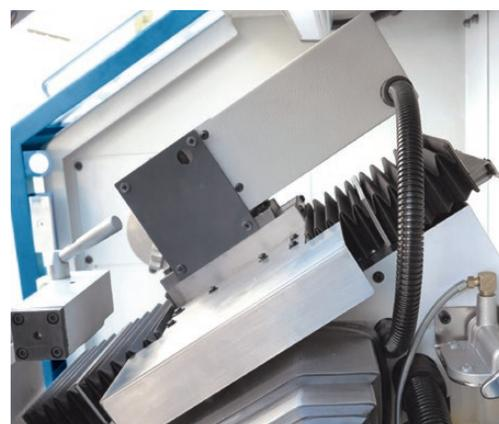
Schrägbettbauweise für optimierten Arbeitsraum und Späneabfuhr
