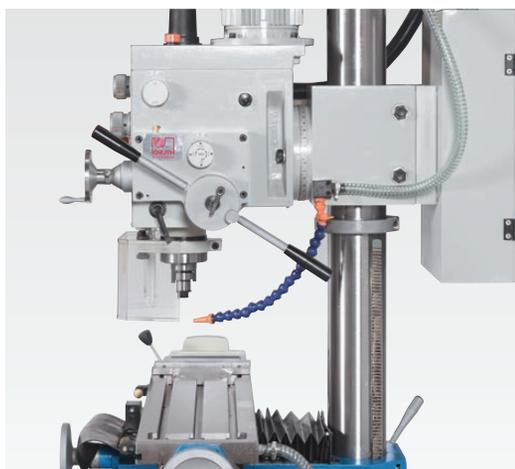
Automatischer Pinolenvorschub mit 3-Stufengetriebe
