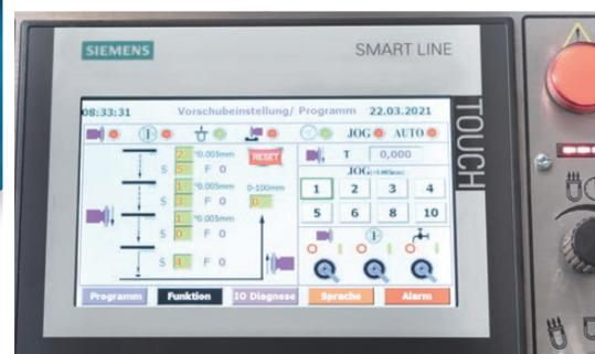
Alle notwendigen Parameter für die präzise Zustellung der Schleifspindel werden direkt am Siemens-Touchscreen erfasst und editiert
