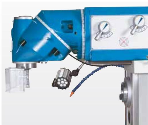
In 2 Ebenen schwenkbarer Universalfräskopf
