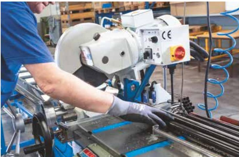
Die Vorarbeit leistet bei Minimax die KHK 350 halbautomatische Kreissäge mit pneumatischer Werkstückklemmung, ebenfalls von KNUTH. Sie bringt die Stahlrohre millimetergenau auf die richtige Länge.
