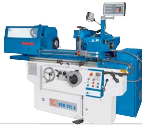
Rund- und Werkzeug-Schleifmaschine
