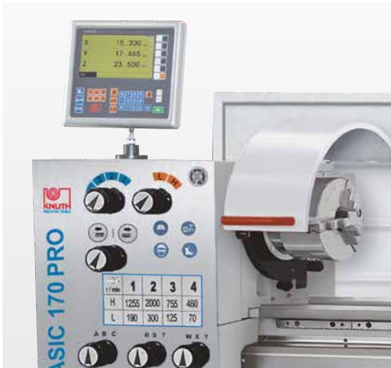
Positionsanzeige für die X-, Z- und Z1 Achse
