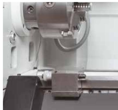
Der Mikrometer-Bettanschlag garantiert Wiederholgenauigkeit
