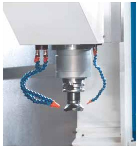
Spindelaufnahme mit Messerkopf
