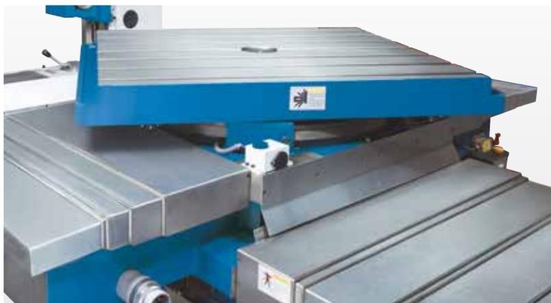
Aufspanntisch ist mit motorischen Vorschub schwenkbar und wird hydraulisch geklemmt
