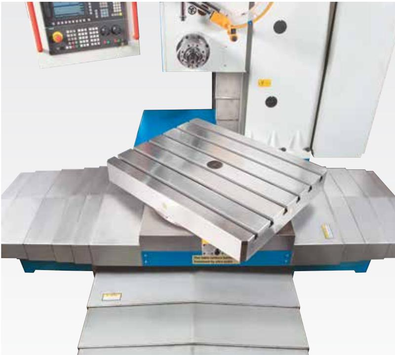
360° drehbarer Arbeitstisch mit gehärteter Oberfläche
