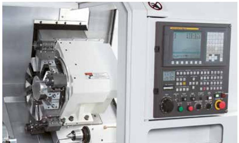
Revolver mit Servomotor und bidirektionaler Werkzeugwahl
