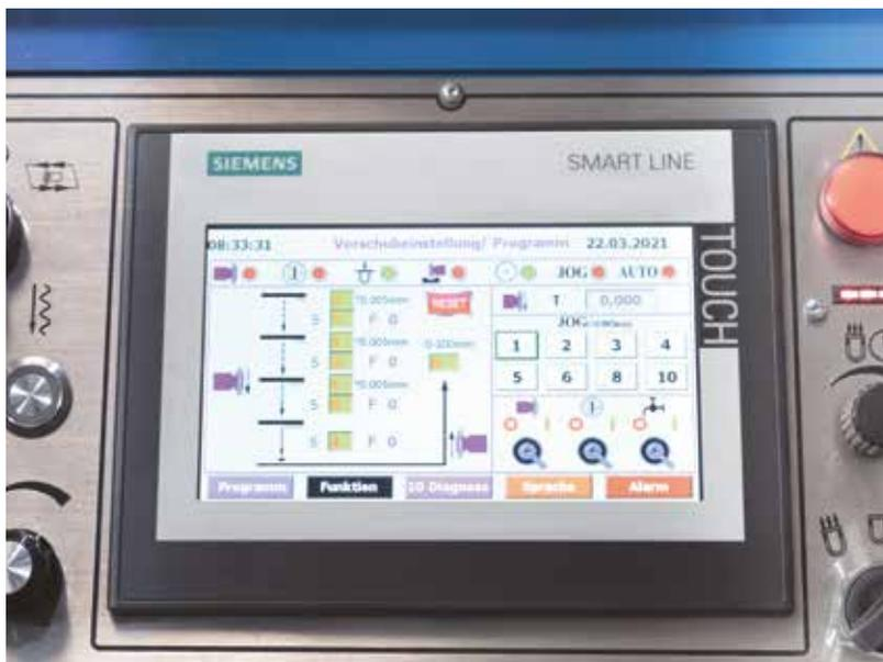
Alle notwendigen Parameter für die präzise Zustellung der Schleifspindel werden direkt am Siemens-Touchscreen erfasst und editiert
