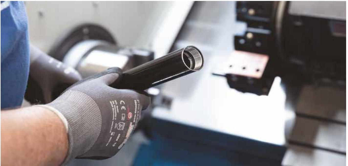
Beim Drehen der Gewinde ist höchste Präzision gefragt. Die Stahlrohre werden später passgenau zu Leitungen für Trockensprinkleranlagen verbunden.
