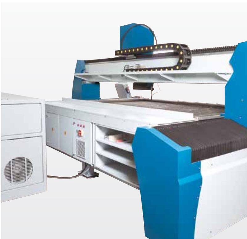
Gegen Wasser und Staub vollständig gekapselte Bewegungseinheiten
