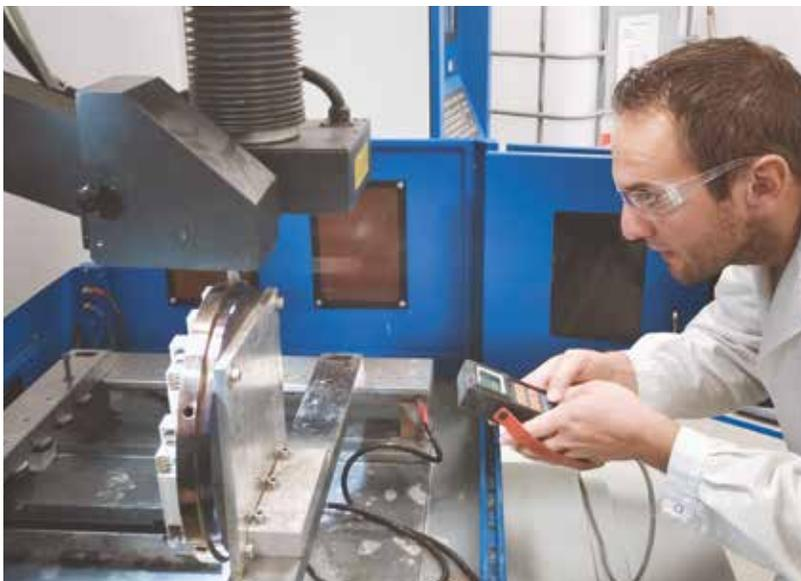
Für eine perfekte Trennung wird die Werkstückgeometrie eingelesen. Hier wurde eine Bauplattform mit Bauteilen aus Edelstahl bearbeitet.
