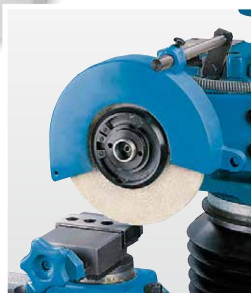
Flachsleifen mit winkelverstellbarem Schraubstock
