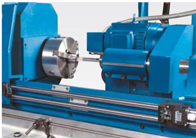
Schleifspindelstock kann zum Wechseln von Innen- zum Außenschleifen um 180 ° gedreht werden
