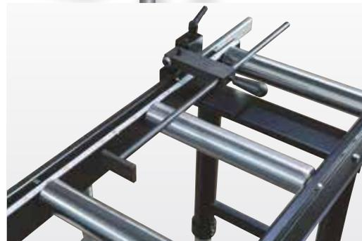
Die Schnittlänge ist mit der gut lesbaren Skalierung exakt einstellbar
