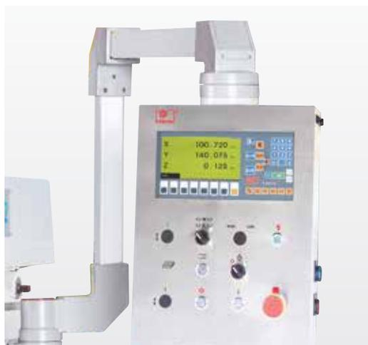
Schwenkbares Bedienpult mit integrierter Positionsanzeige für komfortable Bedienung
