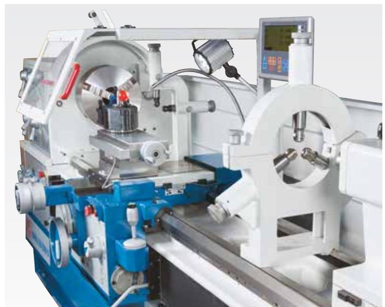
Lünetten zur präzisen Bearbeitung langer Werkstücke
