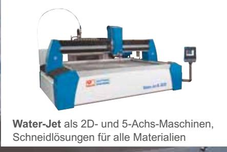
**Water-Jet** als 2D- und 5-Achs-Maschinen, Schneidlösungen für alle Materialien
