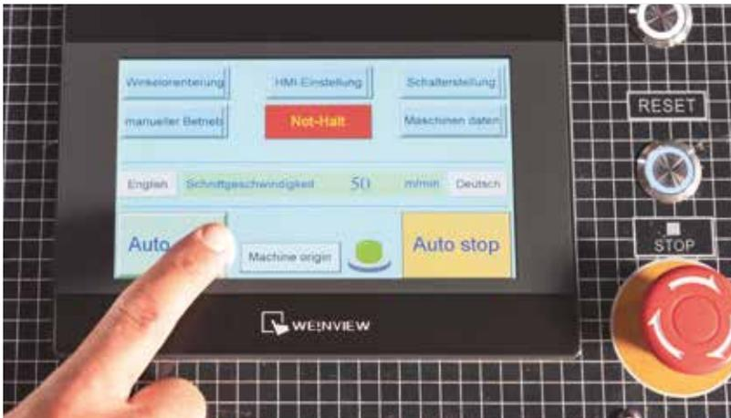
Im automatischen Modus können die Vorschublänge, der Schnittwinkel und die Anzahl der Schnitte in der jeweiligen Konfiguration programmiert werden
