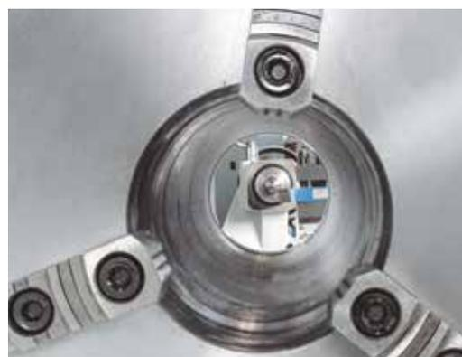
Spindelbohrung bis 225 mm
