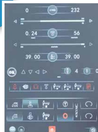
Hochauflösender Touchscreen mit kratzfester Oberfläche. Zum Bohrer passende Drehzahlen und Vorschubgeschwindigkeiten können von einer Datenbank abgerufen und automatisch übernommen werden.
