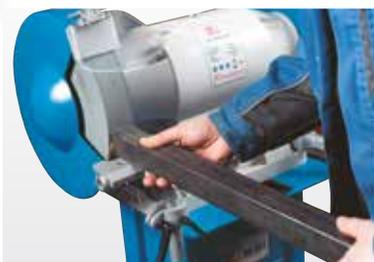
Stabile, breite Materialauflage für sicheres Arbeiten
