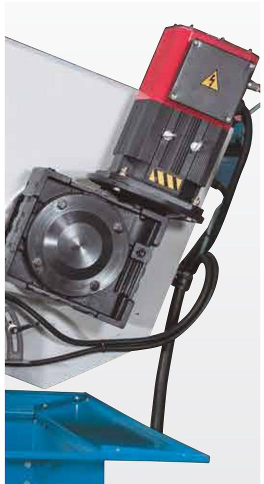
Stufenlos regelbare Bandgeschwindigkeit über Servomotor
