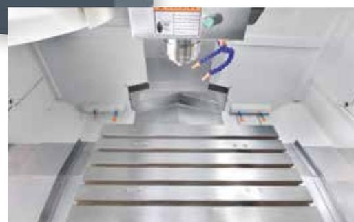
Die Führungen in allen Achsen sind durch robuste Edelstahlabdeckungen geschützt
