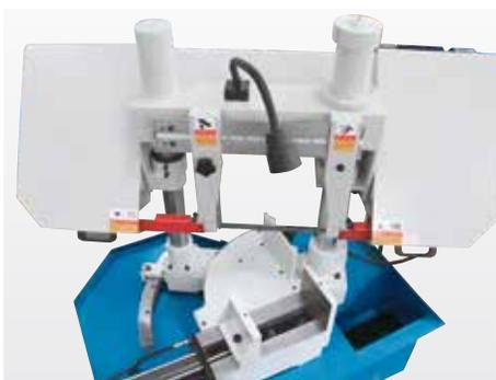
Schwenkbarer Sägebügel, doppelsäulengeführt
