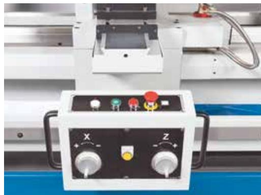
Kompakte Bedieneinheit mit elektronischen Handrädern
