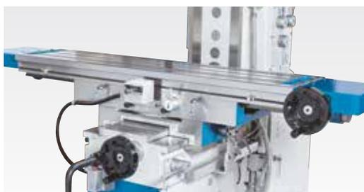
Der Frästisch verfügt über eine große Aufspannfläche und kann in Längsrichtung geschwenkt werden
