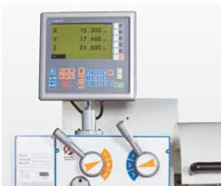
Positionsanzeige für X-, Z- und Z1-Achse
