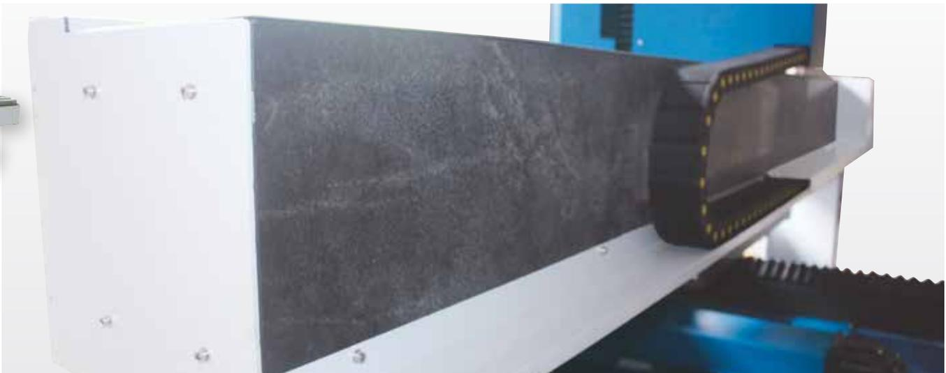
Präzisionsgeschliffene Granitelemente in allen Achsen
