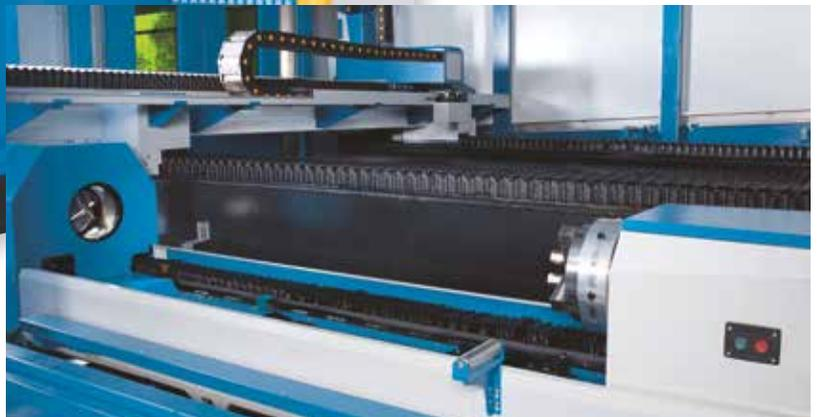
Option: Rohrschneideeinrichtung bis 100 mm Durchmesser und 3 m Rohrlänge
