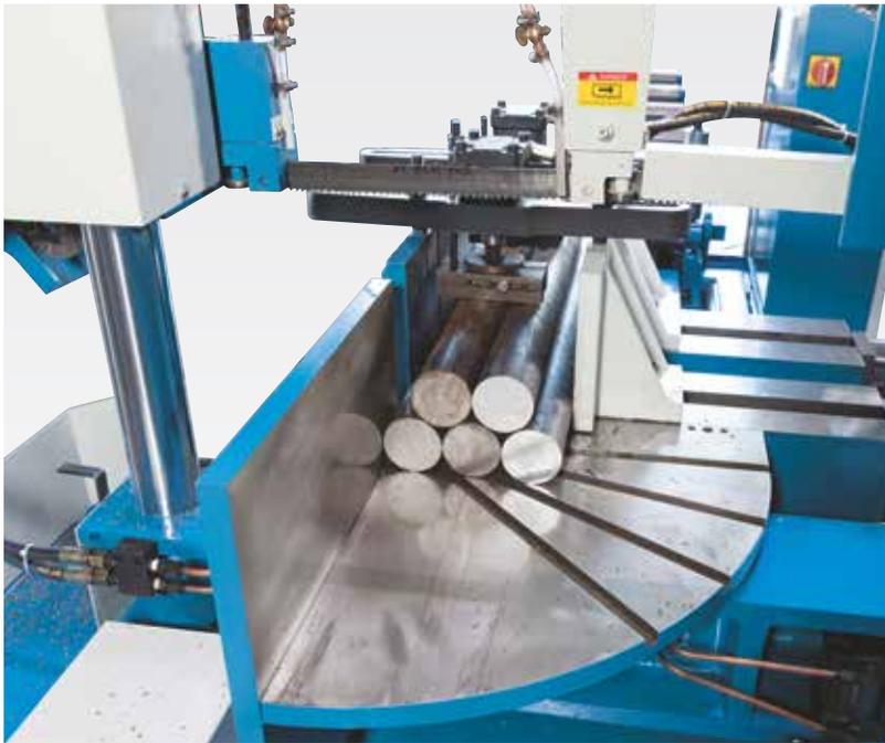
Hydraulische Bündelspanneinrichtung für beide Schraubstöcke serienmäßig
