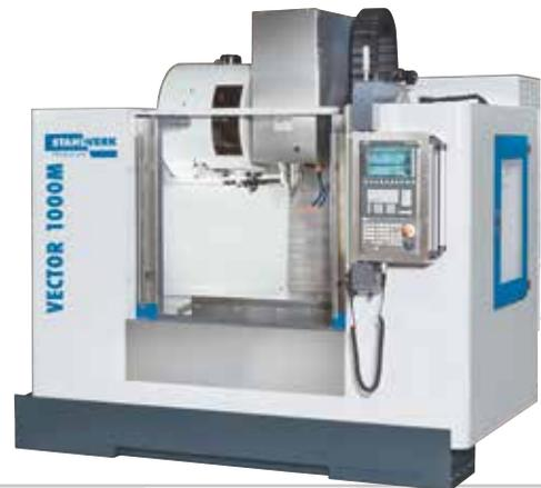
CNC Gravier- und Fräsmaschine
