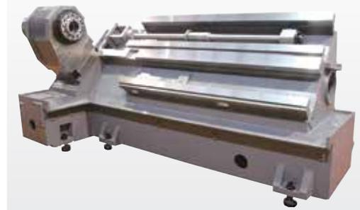
Schweres Maschinenbett mit gehärteten und geschliffenen Führungen
