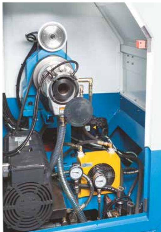
Die Spindelbohrung im Zugrohr beträgt 48 mm
