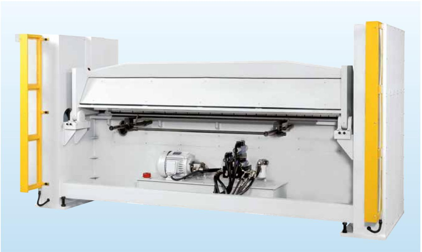
Rückansicht der Maschine - manueller Hinteranschlag
