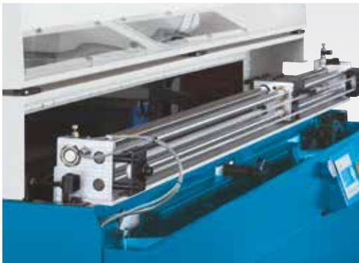
Flexible Verarbeitung von Materialstangen bis 65 mm Durchmesser
