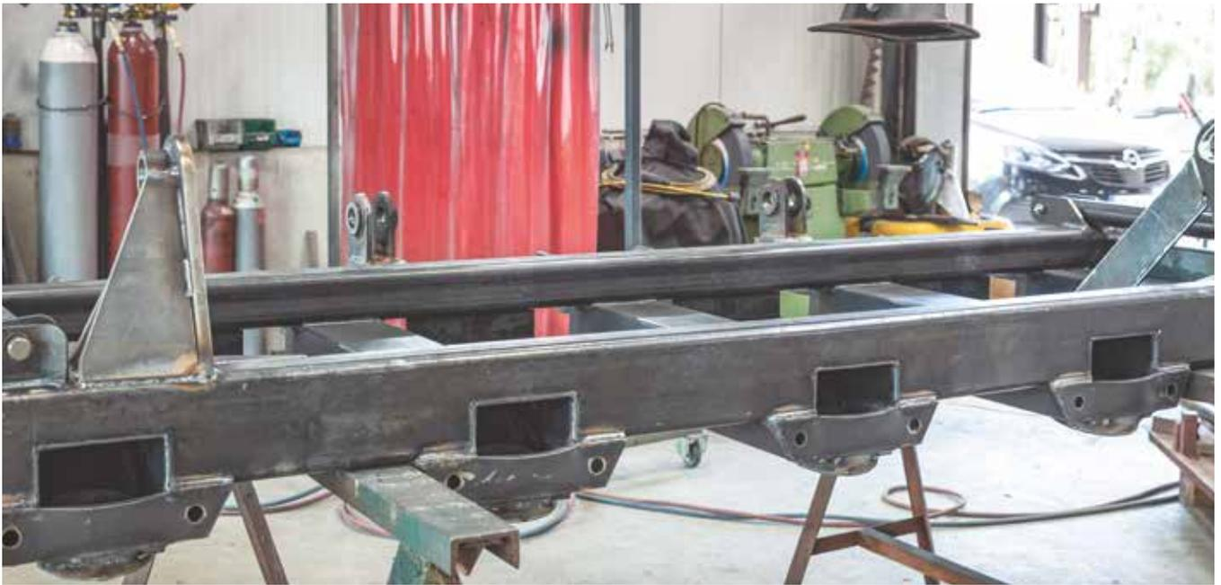
Ein Fertigteil, geschweißt aus einer Vielzahl von Schneidteilen, die mit der KNUTH Plasma-Jet gefertigt wurden
