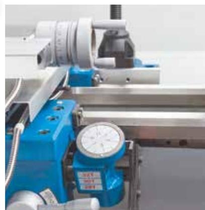
Die Gewindeuhr gewährleistet die Wiederaufnahme des Gewindegangs, nachdem die Schlosnmutter für die rückläufige Bewegung geöffnet wurde
