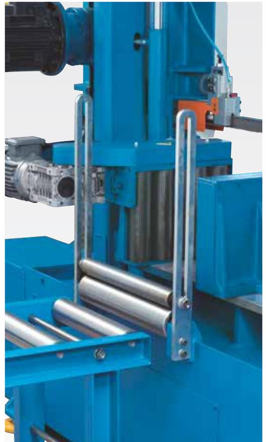
Stabile Zufuhrrollenbahn und Materialführung für Werkstückbündel
